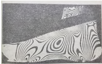
2. Картина дифференциальных напряжений в модели эластичной стопы.
