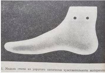
1. Модель стопы из упругого оптически чувствительного материала.
